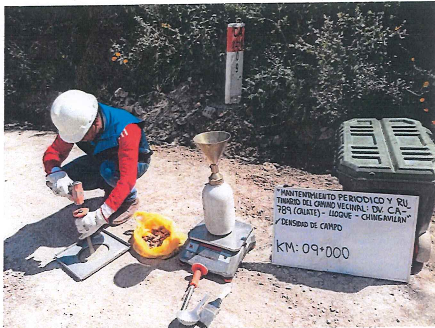
FIGURA N° 37. Ensayo de Densidad de Suelo en Campo. Progresiva 09 + 000 (Método del cono de arena).
