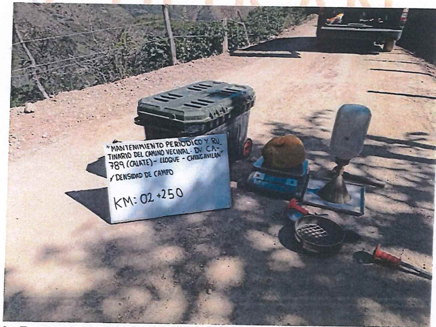
FIGURA N° 10. Ensayo de Densidad de Suelo en Campo. Progresiva 02 + 250 (Método del cono de arena).
