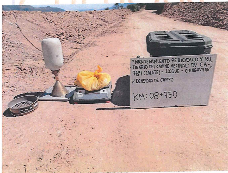
FIGURA N° 36. Ensayo de Densidad de Suelo en Campo. Progresiva 08 + 750 (Método del cono de arena).
