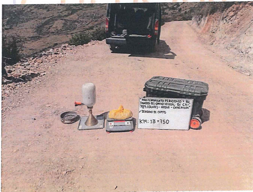
FIGURA N° 56. Ensayo de Densidad de Suelo en Campo. Progresiva 13 + 750 (Método del cono de arena).
