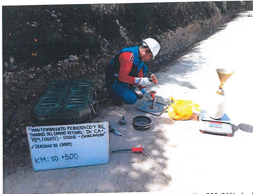
FIGURA N° 43. Ensayo de Densidad de Suelo en Campo. Progresiva 10 + 500 (Método del cono de arena).
