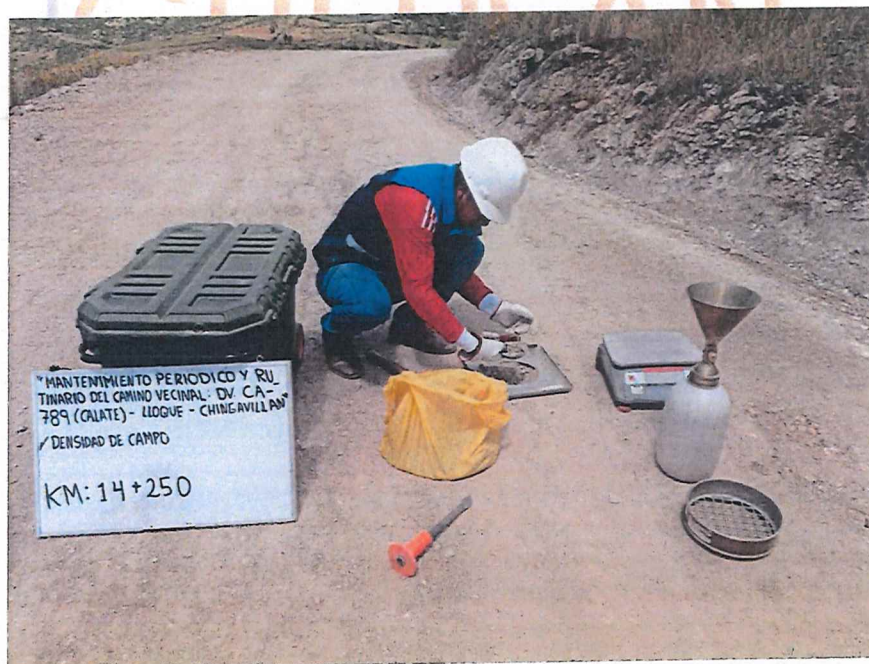
FIGURA N° 58. Ensayo de Densidad de Suelo en Campo. Progresiva 14 + 250 (Método del cono de arena).
