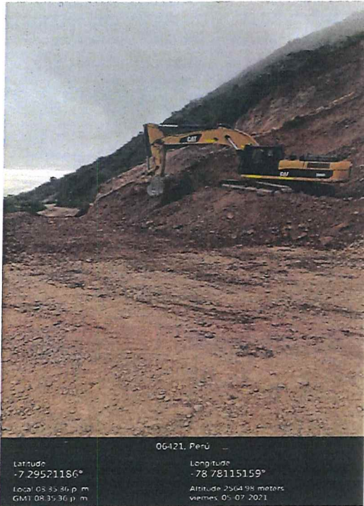
Ilustración 4. Extracción de material de la cantera
