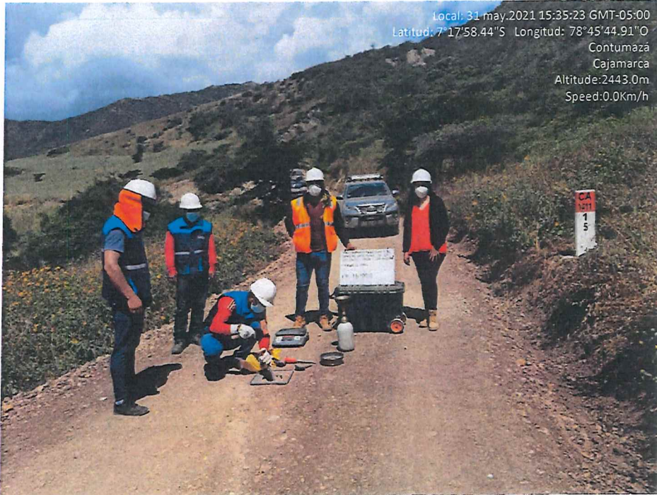
Ilustración 11. Realizando la prueba de densidad en campo.
